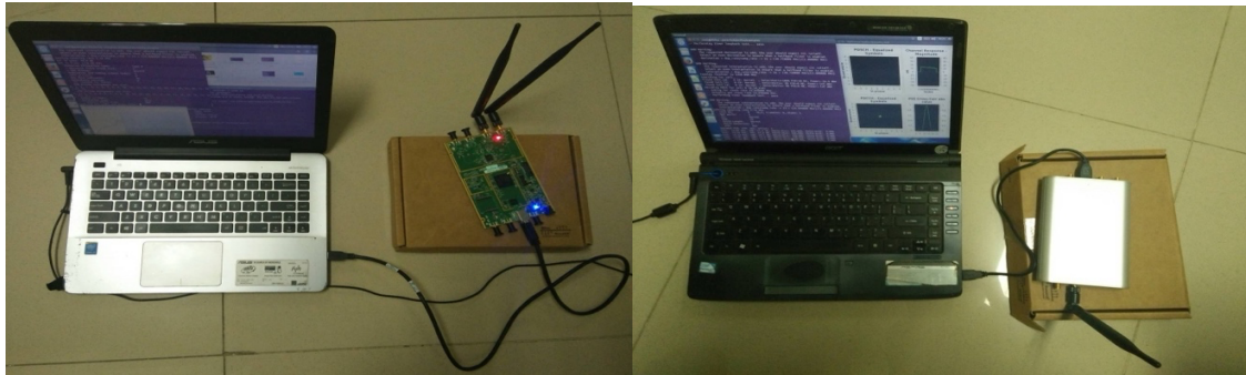
Gambar 6 Konfigurasi Tx-Rx Menggunakan USRP B210
